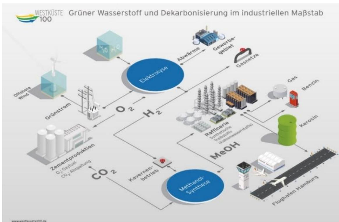
Abbildung 46: Westküste100: Grüner Wasserstoff und Dekarbonisierung im industriellen Maßstab<sup>426</sup>
