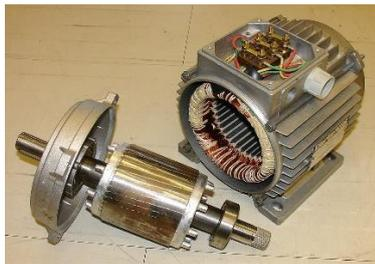
**Abbildung 12: Stator und Rotor eines Elektromotors<sup>171</sup>**
